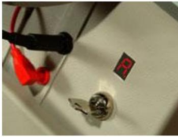
Installato sul carrello motore si trova un display digitale di controllo, che indica quando il montascale funziona correttamente e che segnala eventuali guasti.
